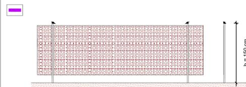
All'interno del cantiere, tutte le aree temporanee, sia di logistica che operative dovranno essere delimitate con una recinzione realizzata con rete in pvc termofusibile, alta 1,50 mt. con paletti in ferro infissi ed ancorati nel terreno, posti ad interasse massimo di 2,00 metri, impilgita con fili in acciaio al piade, in sommità e a crociera, non scavalcabile ma rimovibile.
