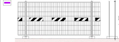
La recinzione delle aree di cantiere dovrà essere realizzata con pannelli modulari in acciaio zincato, con tripla banda rifrangente ad alta visibilità su basamenti in c.a. rinforzato. In mancanza della tripla banda rifrangente l'impresa deve fissare sui pannelli della rete in plastica termo fusa ad alta visibilità di colore arancione. I pannelli di rete metallica devono essere conformi alle Direttive CEE n° 92/07, 92/58 e al D.Lgs. 91/08.
